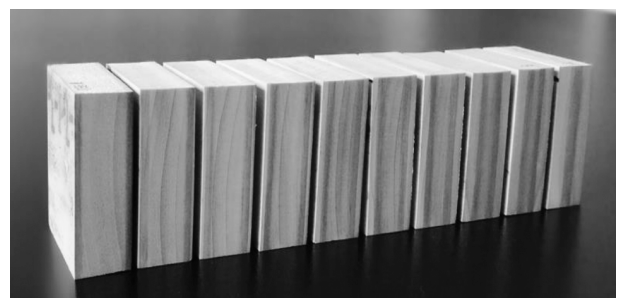
図2 圧縮層の形成部位の異なる層状圧縮材の実物写真
