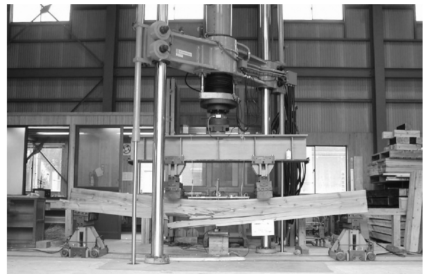
スギ平角材の実大曲げ試験
