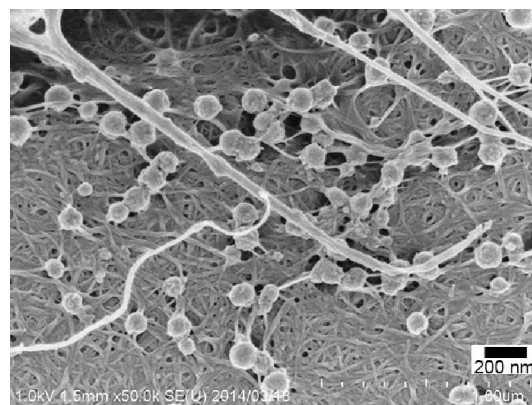
図5 ACCナノセルロースと炭酸カルシウムのナノ複合体
