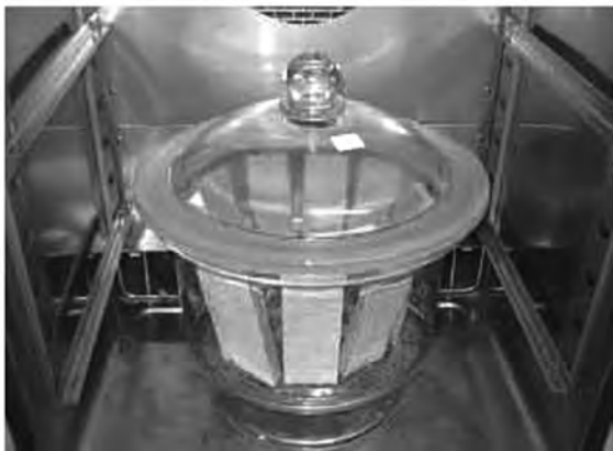
写真1 ホルムアルデヒド放散量試験の様子
