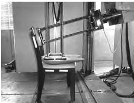
写真2 椅子の背もたれの静的強度試験の様子
