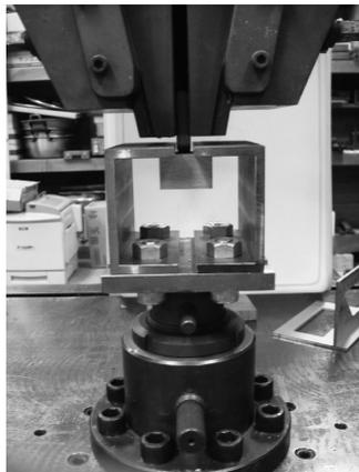
図8 自己接着試験体の木ダボの引抜き試験
