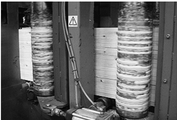
写真2 大断面集成材積層接着工程
