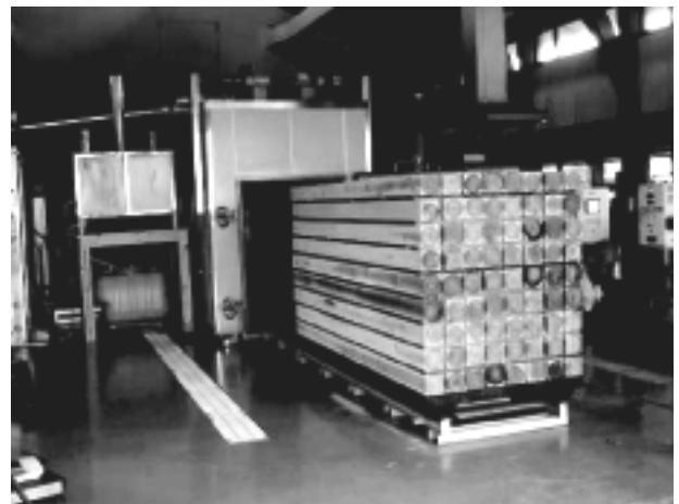
図3 木材乾燥機に併設した凝縮器 (左上のステンレス槽)
