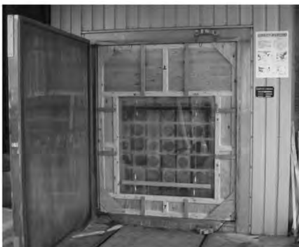
写真1 乾燥機に取り付けたのぞき窓
