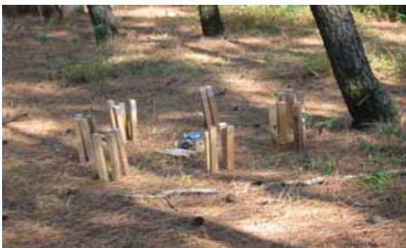
写真1 シロアリ試験杭の設置状況 (宮崎市一ツ葉試験地)
