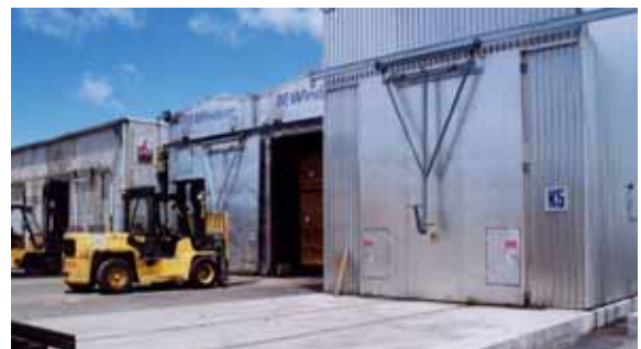
写真1 木質バイオエネルギーによる木材乾燥
