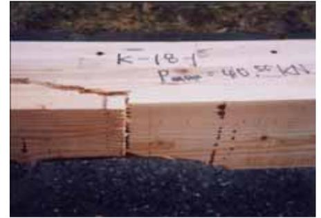
図4 破壊形態(FJ部)
