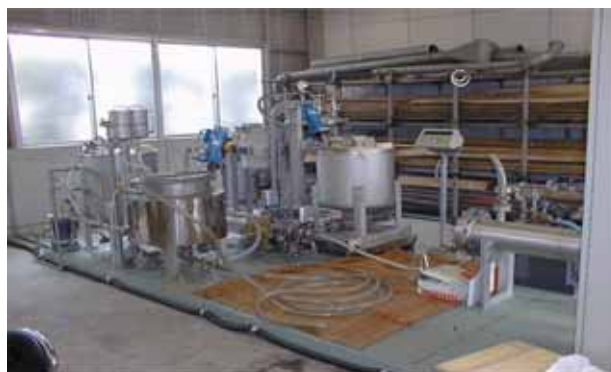
【PF 樹脂製造・注入用小型プラント装置】
